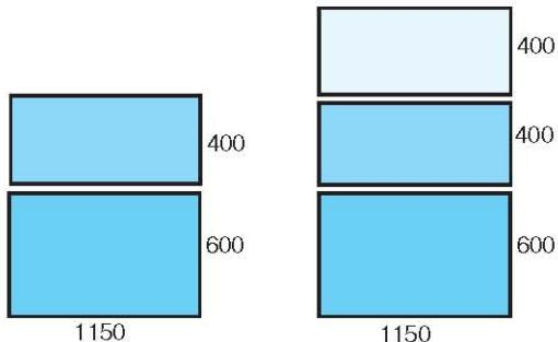
■ При переднем присоединении отсеки размером 350 - 650 мм обеспечивают удобство прокладки кабелей любого сечения.
