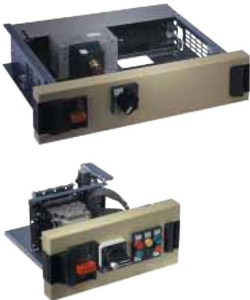
Выкатной элемент в виде выдвижного ящика позволяет создать функциональный блок из нескольких механических объединенных аппаратов, который может устанавливаться в положения "Вкачено/Испытание/Выкачено/Извлечено", допускает выполнение процедур запрета доступа и включает в себя элементы контроля и управления щита на передней панели.
